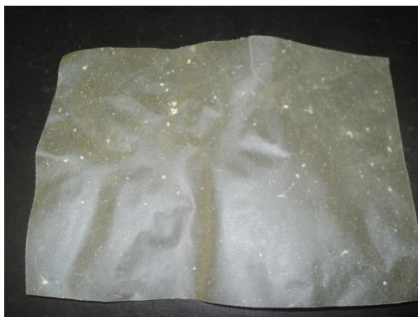
Figura 3- Papel obtido pelo aproveitamento de farelo de arroz.
