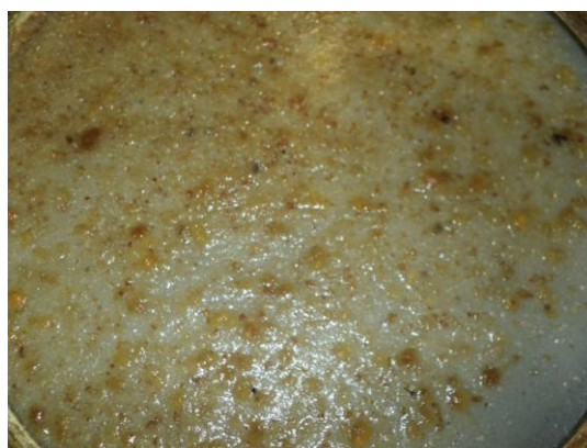
Figura 1 – Polpa celulósica do farelo de arroz após aquecimento com NaOH.
