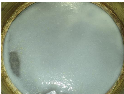
Figura 2- Polpa celulósica após clareamento com hipoclorito de sódio.
